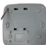
Ослабьте винты на нижней части регистратора и сдвиньте панель.
