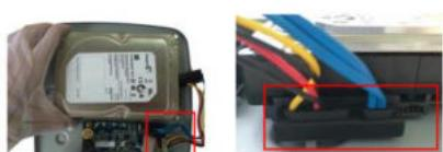
Соедините кабель данных жесткого диска с материнской платой и портом жесткого диска в указанном порядке. Ослабьте крепление кабеля питания на корпусе и соедините другой конец кабеля питания с портом жесткого диска.
