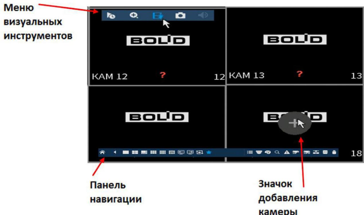
Рисунок 7.10 Добавление IP-камер
