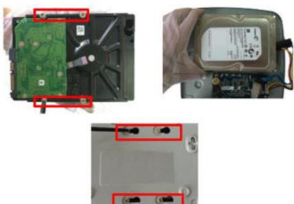
Поместите жесткий диск в кронштейн на корпусе и затем совместите четыре отверстия на корпусе с отверстиями на диске. С помощью отвертки тщательно завинтите винты, чтобы закрепить жесткий диск.
