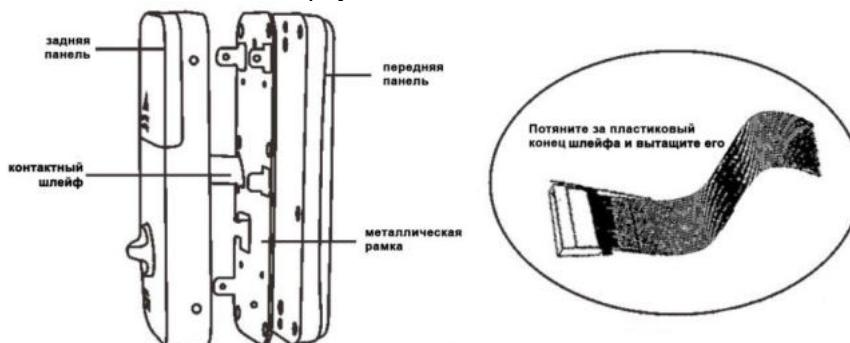
5. С помощью U-образных пазов металлической рамки прищелкните монтажные пластины на дверное полотно, затяните винты, подсоедините шлейф обратно к задней панели корпуса.
