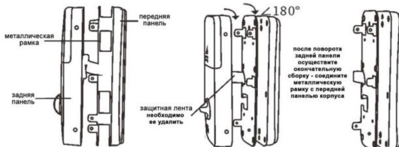
**ВНИМАНИЕ:** после разборки задней панели необходимо удалить контактный шлейф, между передней и задней частями корпуса (смотри п. 4)
