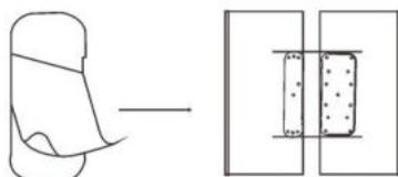
**ВНИМАНИЕ:** после того, как выкрутите винты из задней панели, сначала потяните ее рукой, удалите шлейф и потом окончательно снимите заднюю часть корпуса.
