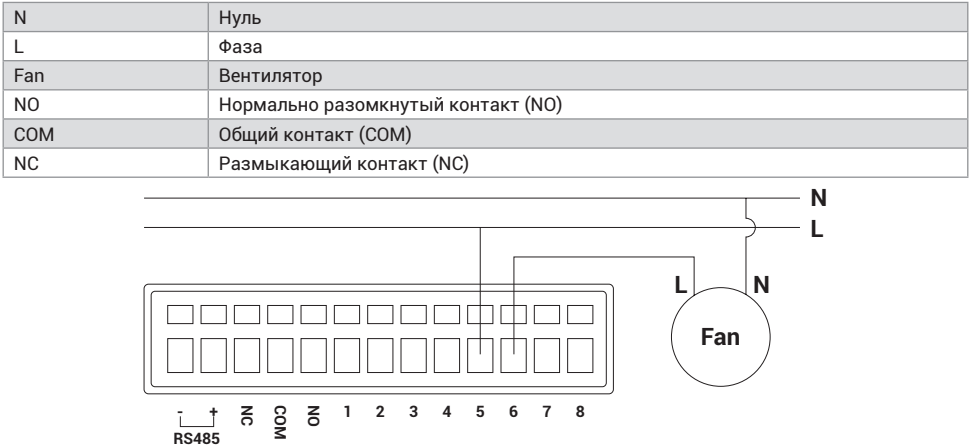
Рис. 2.2 Схема подключения интерфейса входа переменного тока
