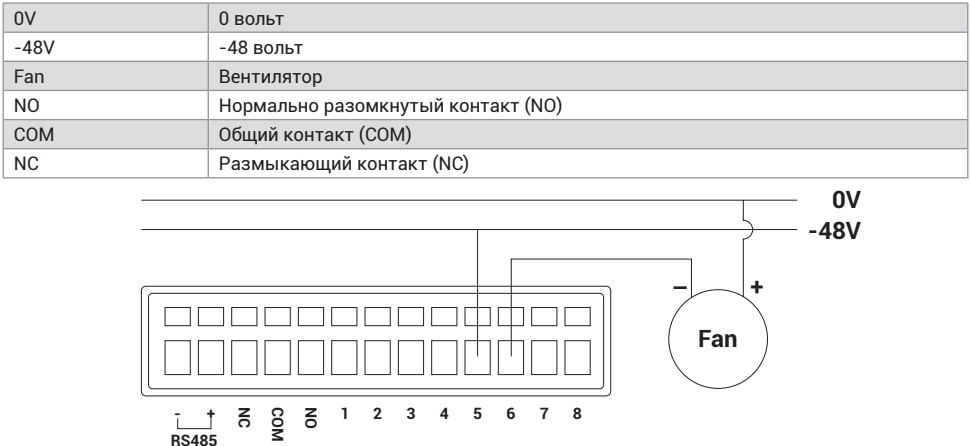
Рис. 2.3 Схема подключения интерфейса входа постоянного тока
