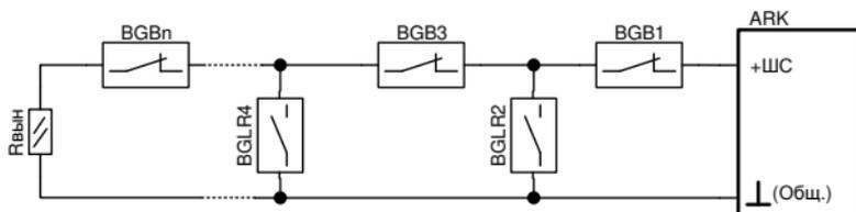
Рисунок Б6. Схема включения охранных извещателей
