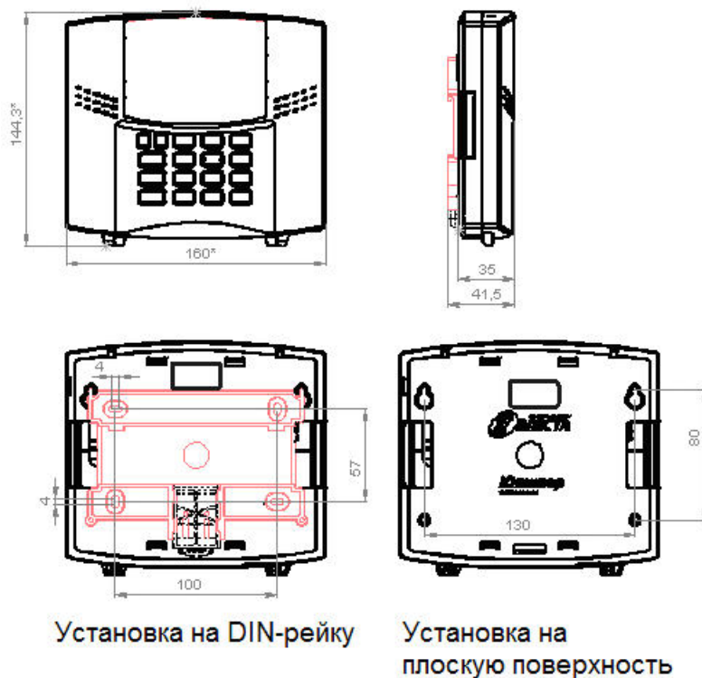
Рисунок 2. Габаритные и установочные размеры прибора
