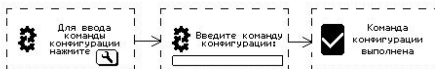
Рис. 6.4 Ввод команды конфигурации со встроенной клавиатуры
