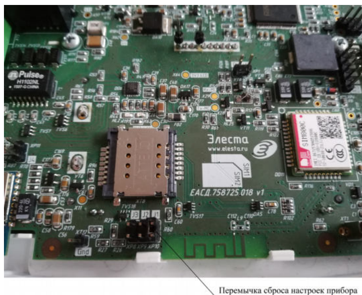
Рисунок 5.1. Перемычка для сброса настроек прибора к заводским установкам.
