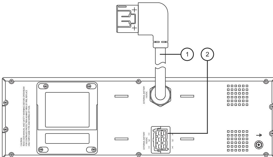
1. Вилка для подключения к ИБП
