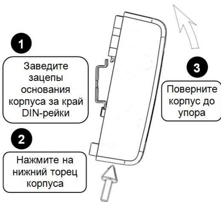
**Рисунок 8.3 Крепление на DIN-рейку**
