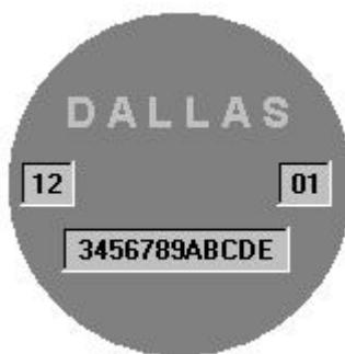
**Рисунок 6.15** Расположение кода на ключе Touch Memory
