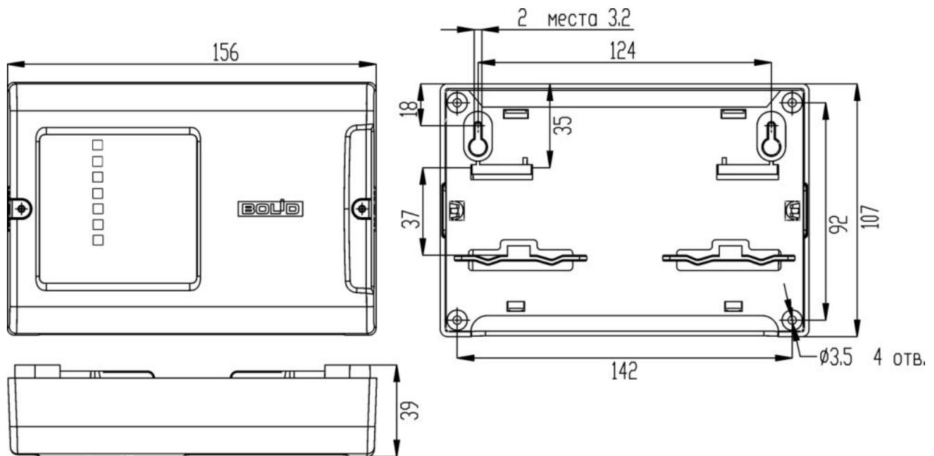
Рисунок 8.1 Габаритные размеры
