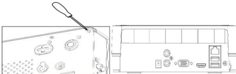
Рисунок 2.1 Демонтаж крышки регистратора
