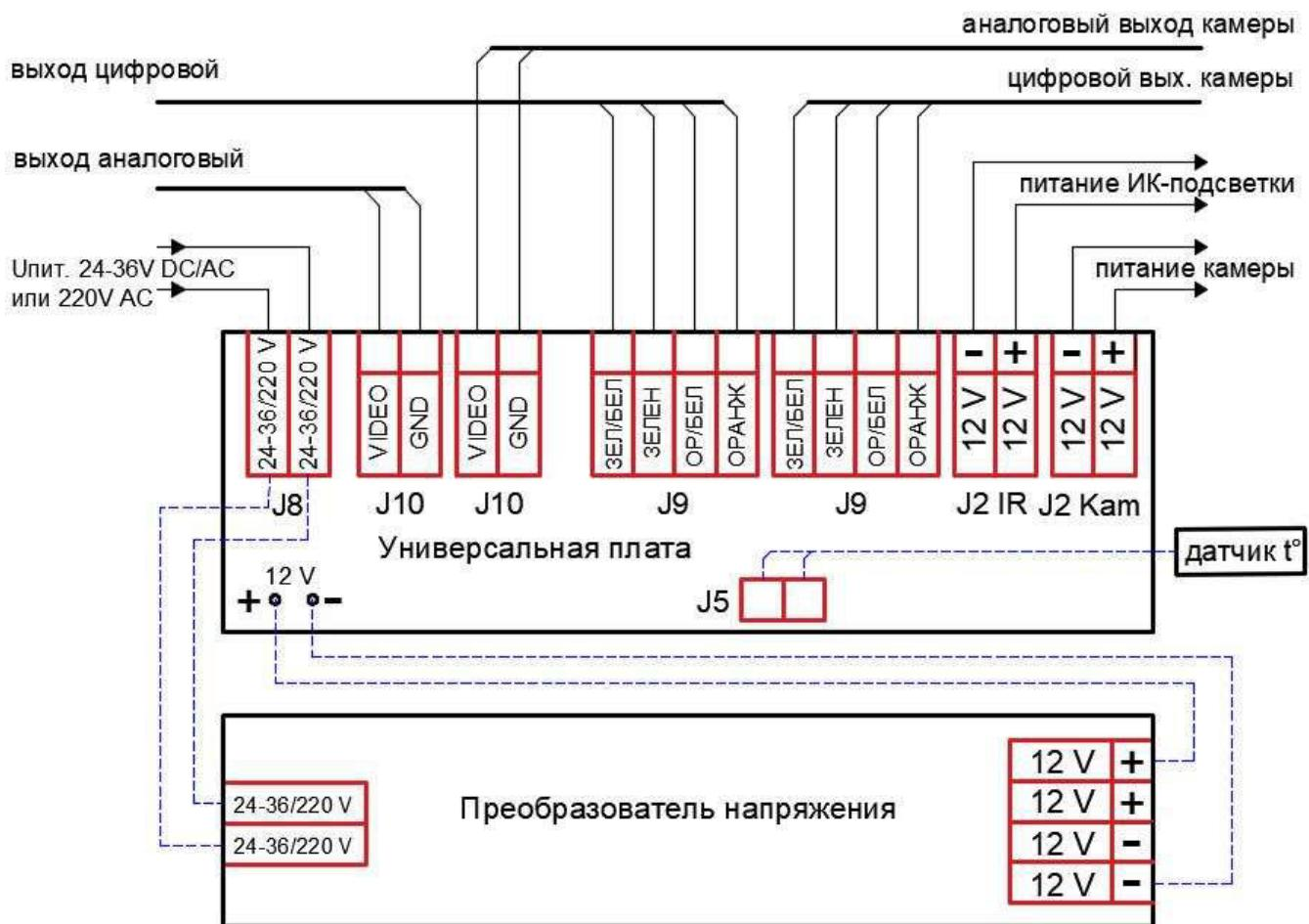
Рисунок 4а. Подключение термокожуха с питанием 24-36 и 220 В
