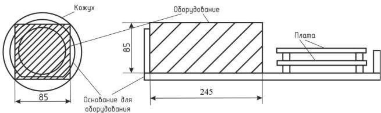
Рисунок 2 – Полезный объем термокожуха для установки видеооборудования
