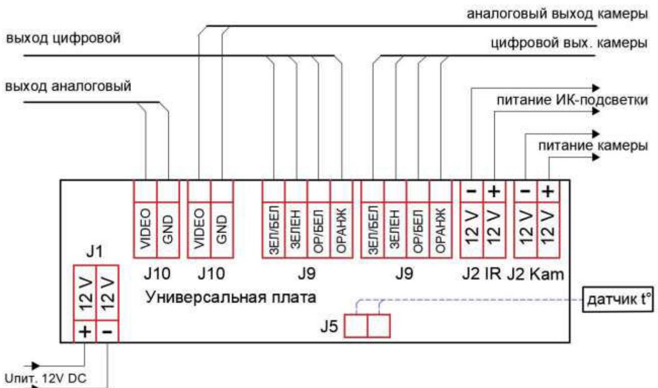
Рисунок 4б. Подключение термокожуха с питанием 12 В
