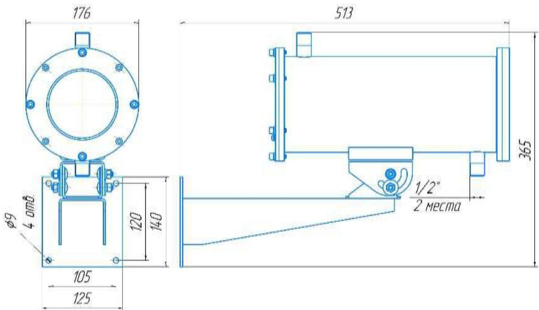
Рисунок 1 – Габаритные размеры термокожуха с крепежно-юстировочным устройством
