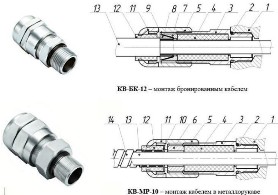
Рисунок 6 – Вводные устройства с двойным уплотнением
