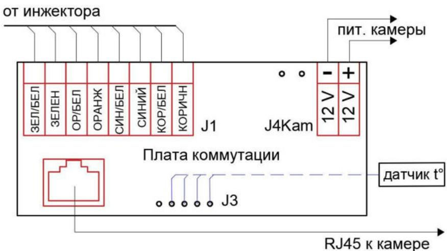
Рисунок 5д – Подключение термокожуха с питанием по PoE
