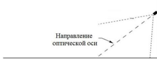
Рисунок 4 – Рекомендуемая установка термокожуха по отношению к горизонту
