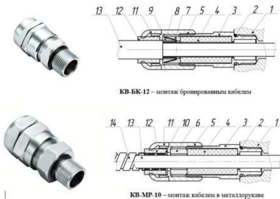
Рисунок 6 – Вводные устройства с двойным уплотнением
