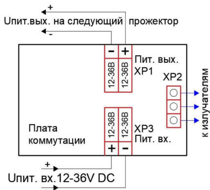
Рисунок 6 – Схема подключения светодиодного прожектора
