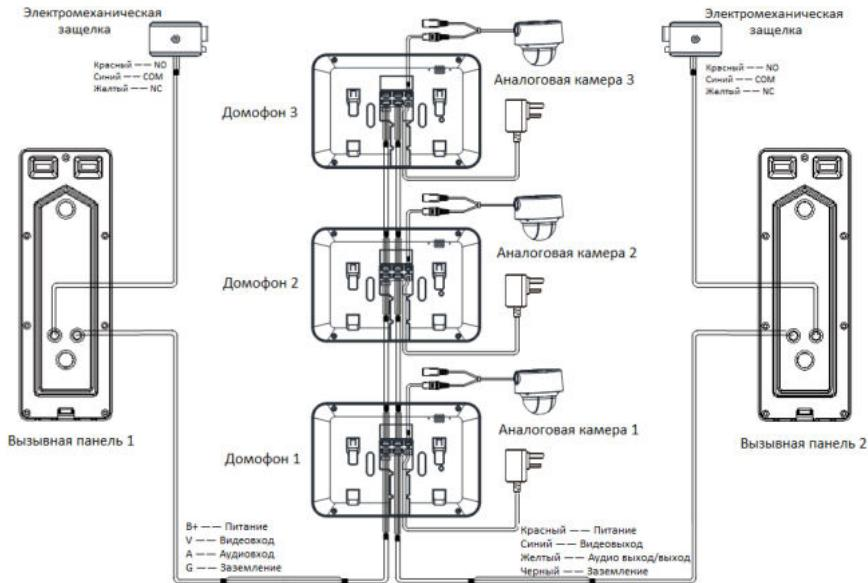
Рисунок 3-5 Подключение 3 (2 вызывные панели и 3 видеодомофона)
