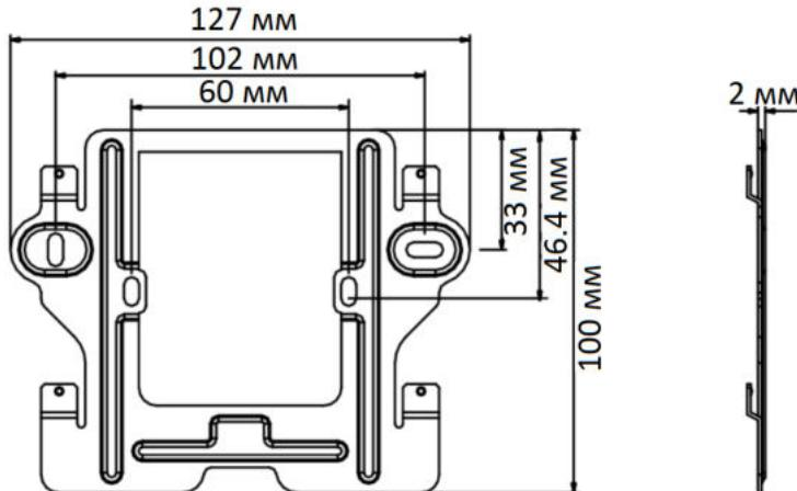
Рисунок 4-1 Монтажное основание
