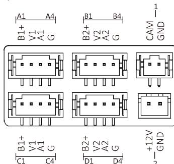
Рисунок 3-1 Разъемы видеодомофона
