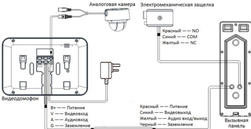
Рисунок 3-3 Подключение 1 (1 вызывная панель и 1 видеодомофон)
