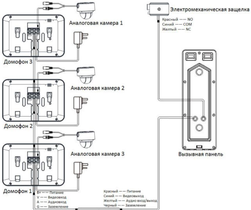
Рисунок 3-4 Подключение 2 (1 вызывная панель и 3 видеодомофона)
