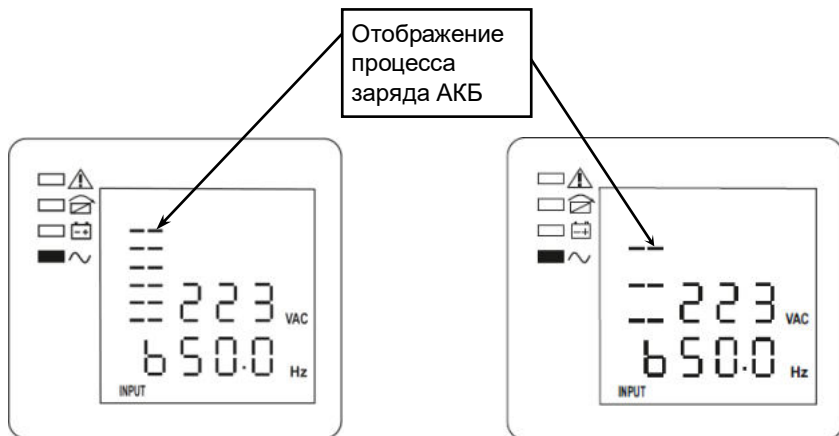
Рисунок 21 — ЖК-дисплей, форсированный (ускоренный) заряд АКБ
