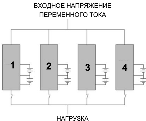
Рисунок 24 — Схема подключения изделий в систему параллельного резервирования.
