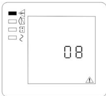
Рисунок 26 – Пример отображения кода неисправности на ЖК-дисплее
