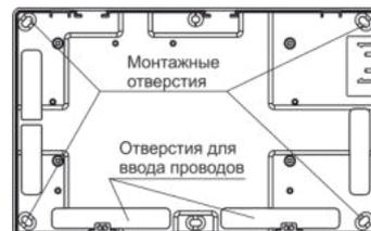
4 Винтами закрепить БРА на несущей поверхности
