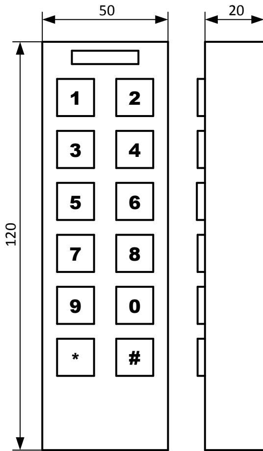
**Рисунок 1.** Внешний вид и габаритные размеры считывателя
