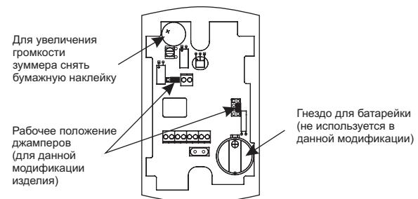
*Рис.1 Размещение элементов.*
