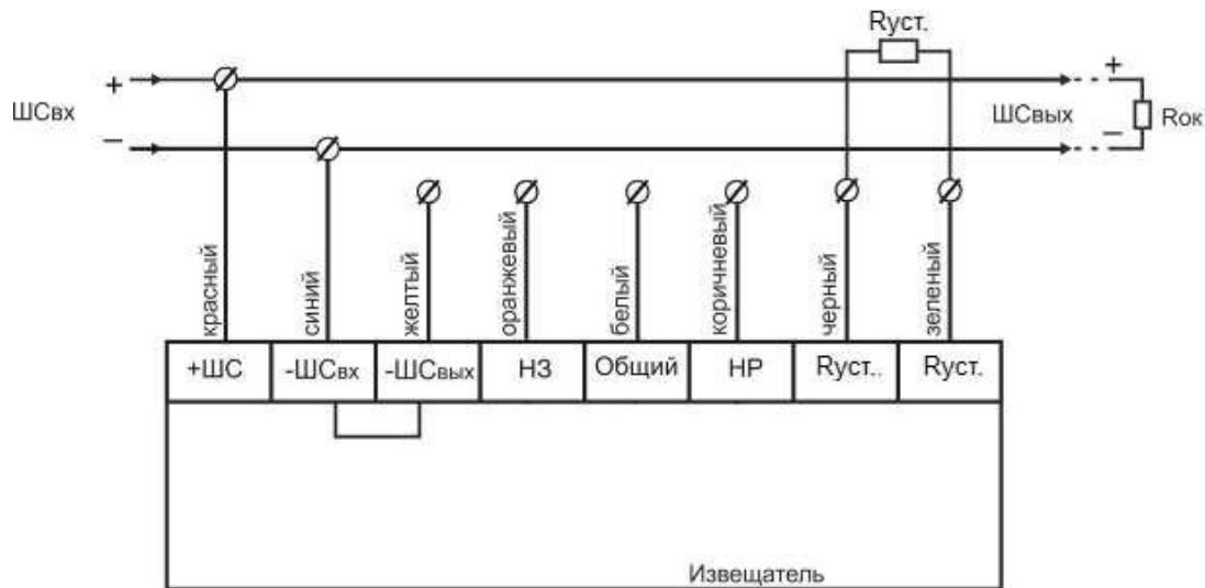
Рисунок 5 – 2-х проводная схема подключения Спектрон-201
