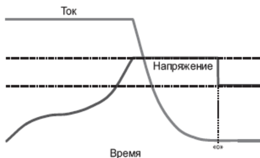
Рис. 3 Зависимость тока и напряжения от времени при заряде по методу IUoU.
