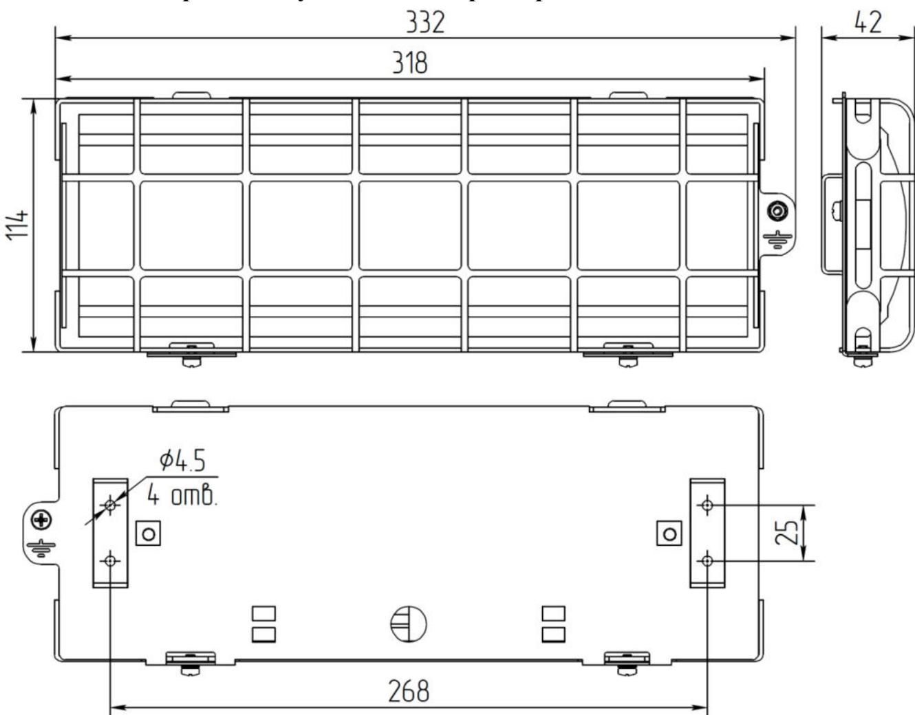
**Габаритные и установочные размеры оповещателя светового ОС**
