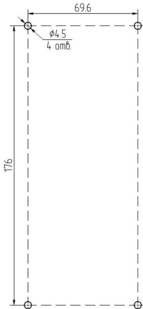
**Габаритные и установочные размеры выносного элемента ЭВ**
