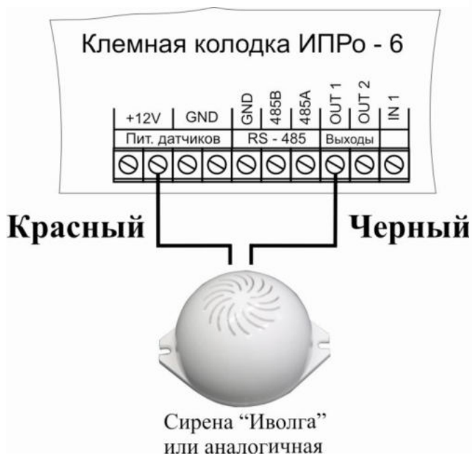
Подключение сирены с током потребления до 1А
