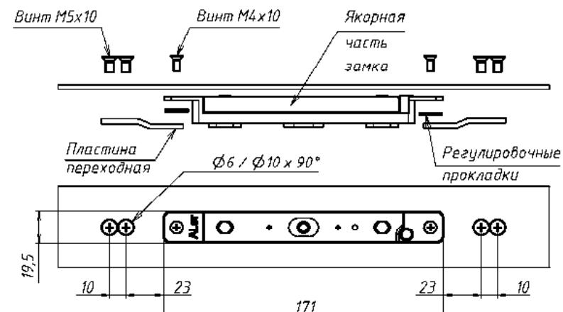
Рисунок 9 – Установка якоря на металлическую дверь
