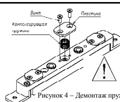
Рисунок 4 – Демонтаж пружины якоря для вертикального варианта замка
