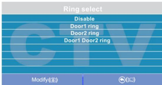
В этом окне можно выбрать, на какую панель установить данную мелодию в качестве мелодии вызова, либо же задать её на обе панели сразу. Для сохранения выбора следует нажать кнопку «Фото». MP3-файлы нельзя удалить, используя меню монитора.
