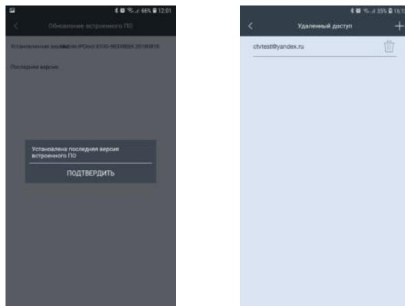
Подраздел «Обновление встроенного ПО» приведен на рисунке слева выше. Если на сервере появится новая версия прошивки, то с помощью этого подраздела на IP-домофон автоматически загрузится новая версия. В противном случае, отобразится сообщение: «Установлена последняя версия встроенного ПО».
