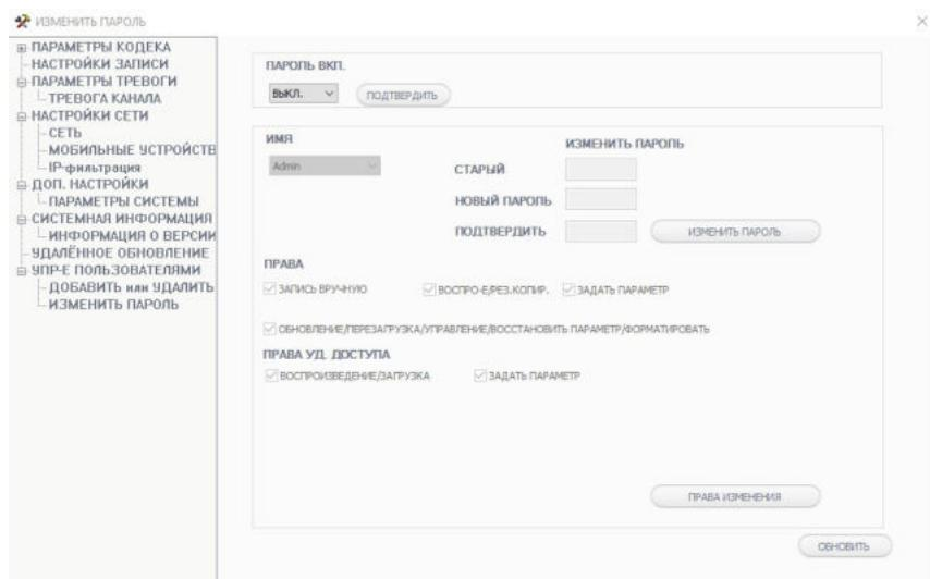
Здесь включается/выключается запрос пароля при входе в систему. Только при включенном запросе пароля доступно изменение паролей администратора и пользователей, а также настройка их прав доступа - локальных и удалённых.
