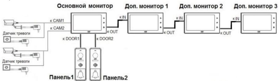
Вызывные панели подключаются только к основному монитору.
