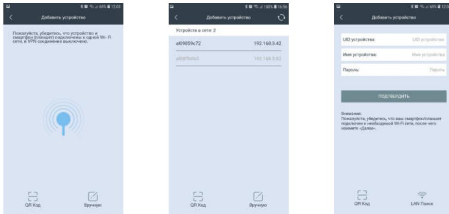
IP-домофон можно добавить только по его номеру UID, добавление по IP-адресу не поддерживается. В процессе добавления, необходимо будет задать имя устройства и указать пароль администратора устройства. В целях безопасности и сохранности корректной работоспособности устройства рекомендуется изменить пароль учетной записи администратора!
