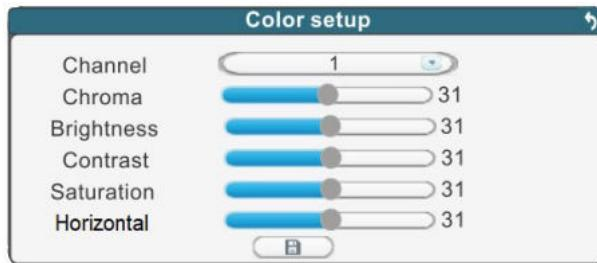
Здесь доступны для регулировки такие параметры изображения, как Chroma (Тон), Brightness (Яркость), Contrast (Контраст), Saturation (Насыщенность) и Horizontal (Сдвиг по горизонтали). По умолчанию, все параметры имеют значение 31 (среднее значение). Отрегулируйте параметры изображения для выбранного канала в зависимости от условий освещения и для сохранения изменений нажмите на значок «Сохранить», расположенного под регулировками.
