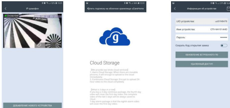
Окно «Информация об устройстве» имеет вид, показанный на правом рисунке выше. Здесь отображается имя устройства, его UID-номер, а также доступны для изменения следующие параметры: 1) пароль для подключения к устройству; 2) сохранить пароль для открытия замка, чтобы не вводить его каждый раз. После изменения значений, нужно нажать значок «Сохранить» в правом верхнем углу окна, иначе введенные значения не будут сохранены.
