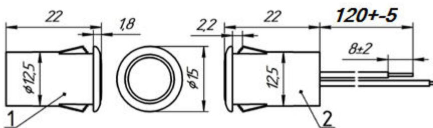
Рис 1. Габаритные и установочные размеры извещателя
