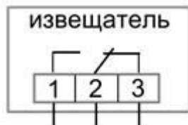
Рисунок 2б. Схема подключения ИО102-51(П)
