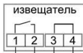
Рисунок 2в. Схема подключения ИО102-51(НР+Пр)
