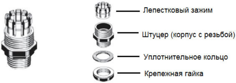
Рис.2 Устройство гермовводов
