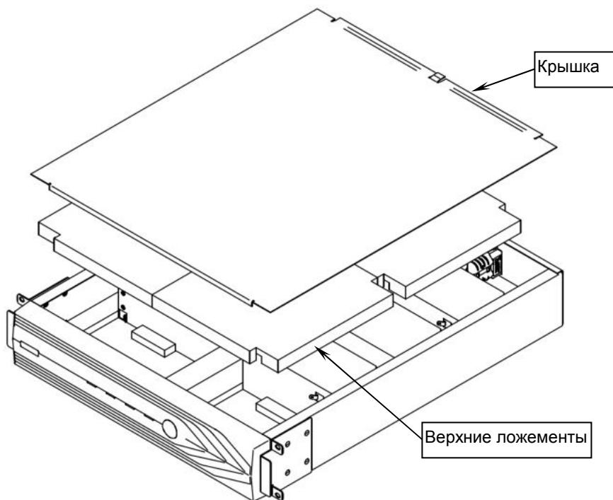
Рисунок 6 — Замена аккумуляторных батарей.
