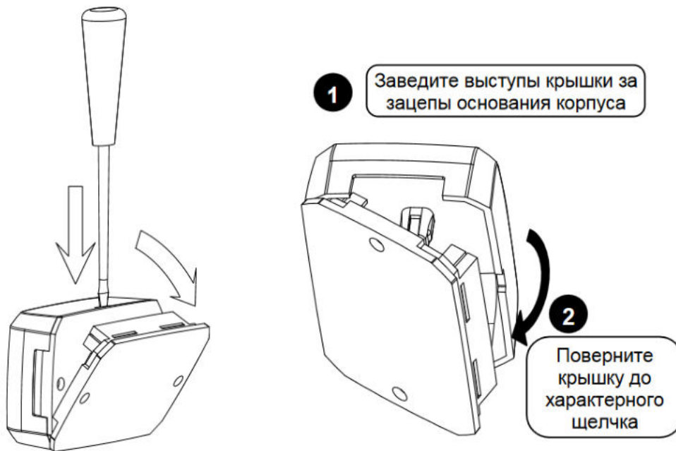
Рисунок 2.3. Снятие и установки крышки преобразователя
