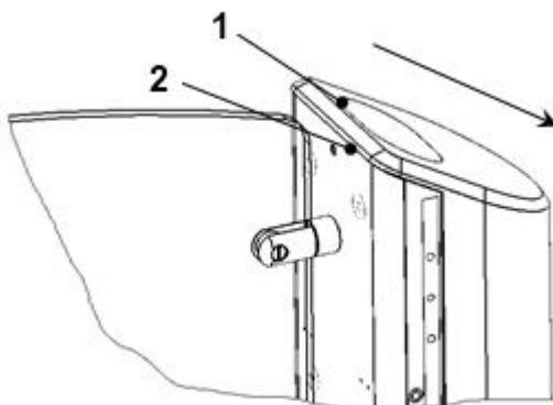
1 - панель индикации; 2 - винт M4
