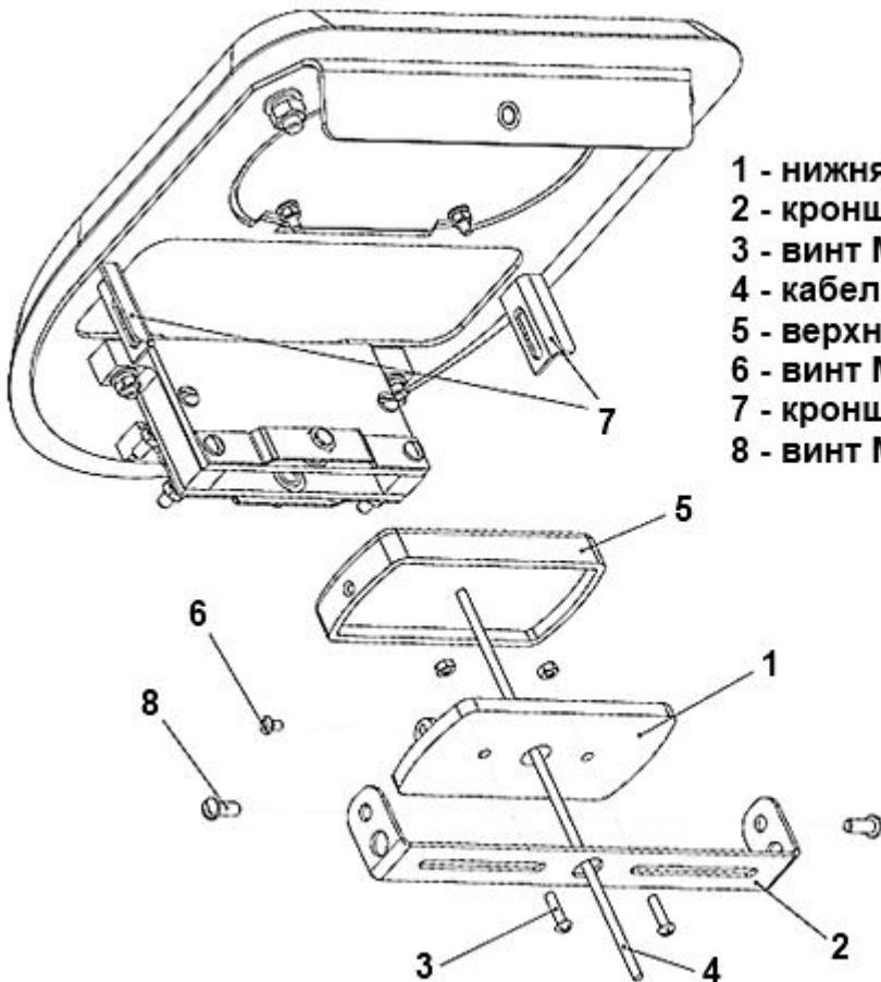
Рисунок 16 – Схема установки считывателя бесконтактных карт
