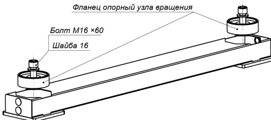
Рисунок 13. Крепление нижней опоры на установочной поверхности
