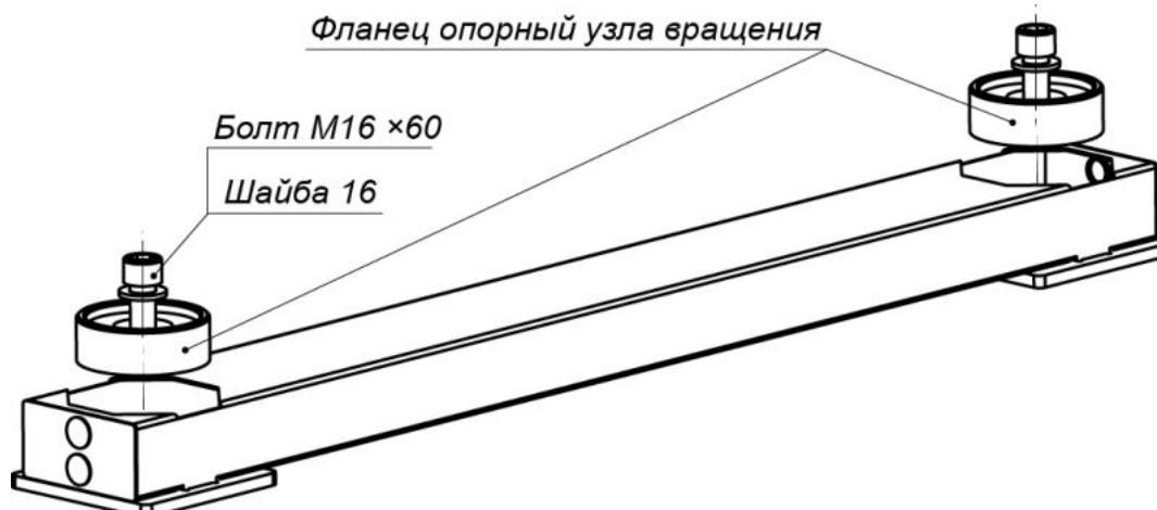
Рисунок 13. Крепление нижней опоры на установочной поверхности
