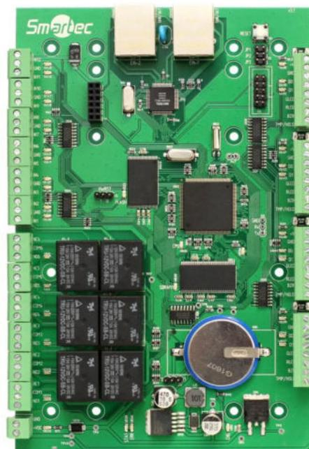
Контроллер нового поколения ST-NC441B предназначен для построения сетевых систем контроля доступа на базе программного обеспечения «Таймекс». В случае отсутствия постоянного подключения к серверу, система продолжает выполнять свои функции в автономном режиме с полным сохранением работоспособности.
