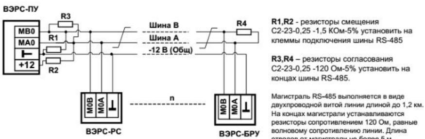
Подключение приборов на шине RS-485 №1
