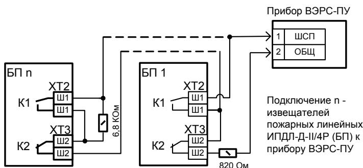
Рисунок Б5. Схема включения п линейных дымовых извещателей ИПДЛ-Д-II/4Р в ШСП.
