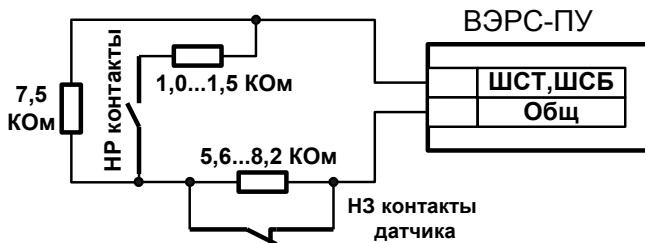
Рисунок Б7. Схема включения технологических датчиков в ШСТ и контактов дверной блокировки в ШСБ.
