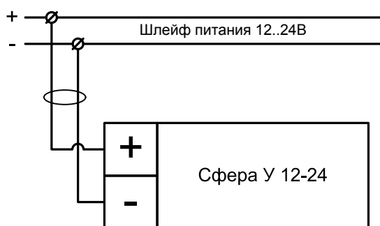
Схема подключения оповещателя Сфера (уличное исполнение); питание постоянным током 12-24В.
