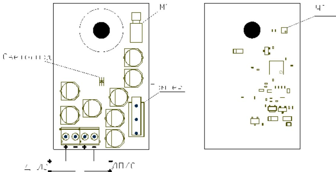
**Рисунок 10.** Схема подключения извещателя к двухпроводной линии связи.
