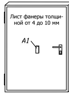
**Рисунок 7.** Защита деревянной пустотелой двери
