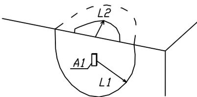
Рисунок 4. Защита смежной конструкции. ( $L2 = 3/4 L1$ )
