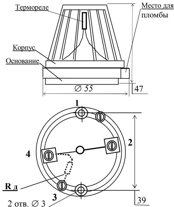
Рис. 1. Общий вид, габаритные и установочные размеры извещателя «МАК-1» исп. 01\* (он же ИБ)
